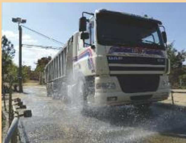
Le bac laveur de roues en sortie de carrière.
